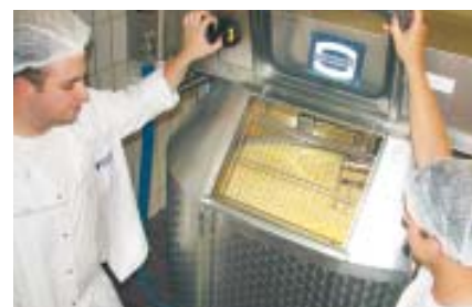
Beim Schnittkäse wird Lab zugesetzt, das Ei-weiß fällt aus und wird anschließend mit dem Rührwerk zerschnitten. Fotos: Borlinghaus
